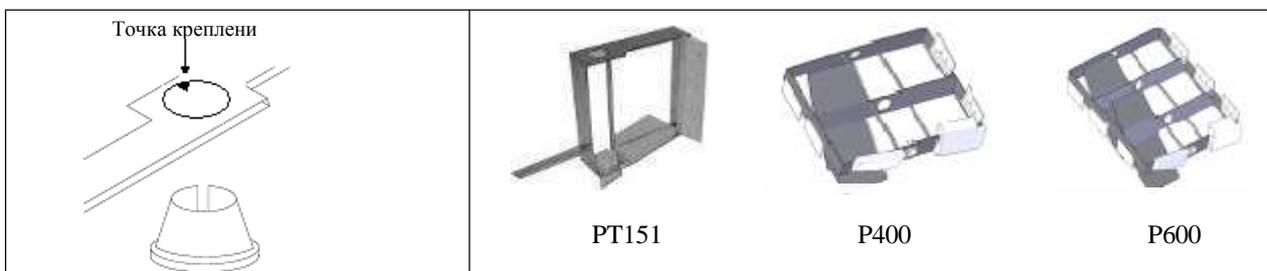
RU **ВНИМАНИЕ:** для половины партии (3 л для модели PT151, 5 л для моделей P400-P600) снимите верхнюю лопасть мешалки (1 × PT151) (1 × P400) (2 × P600).
