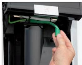
*Повернуть фиксатор на 180°*
